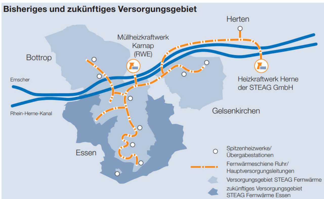
Abbildung 4: Trassenverlauf Fernwärmeschiene Ruhr (STEAG Fernwärme GmbH, 2021)
