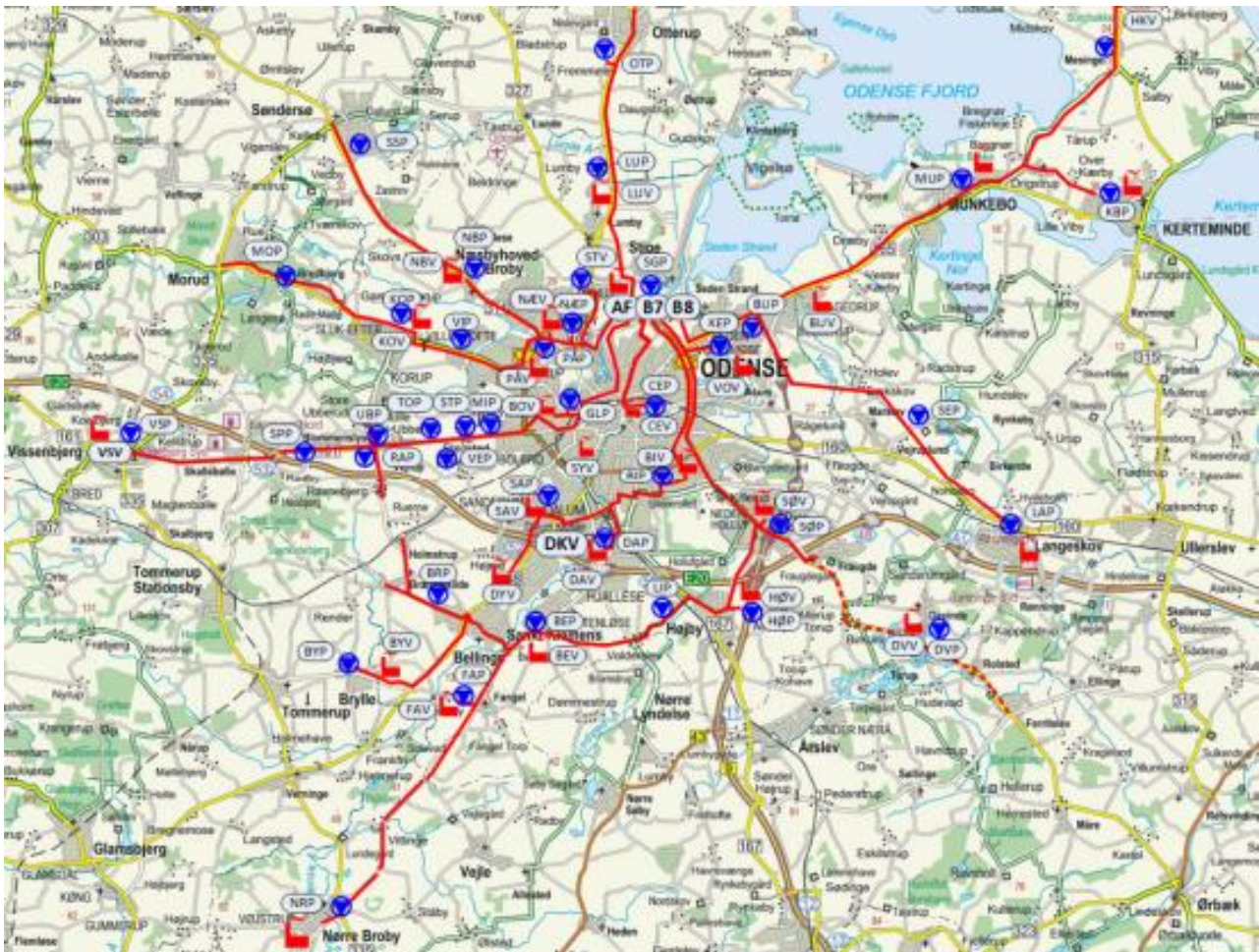
Abbildung 10: Trassenverlauf Übertragungsnetz Fjernvarme Fyn (Strømvig, 2018)
